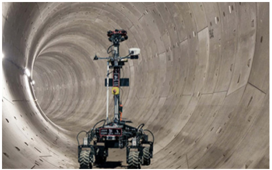
圖 9 隧道自走式探測機器人
