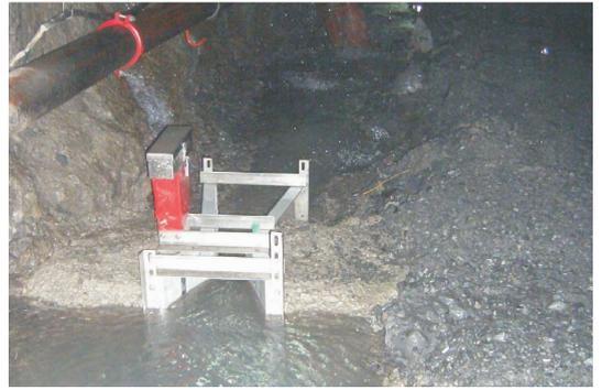
图 3 CTF - 01 量水堰现场装设情形
