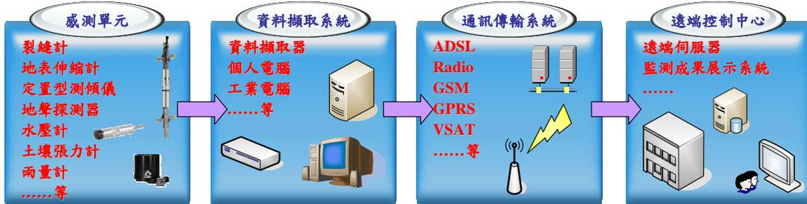
圖 6 全自動監測系統示意圖
