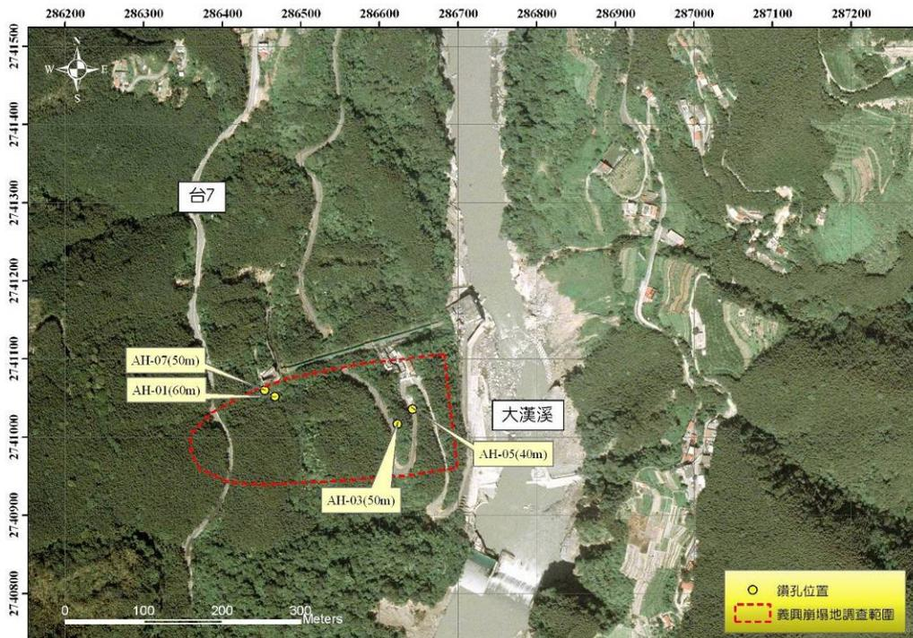
圖 9 義興崩塌地地質鑽孔佈置圖（航照日期：2007）
