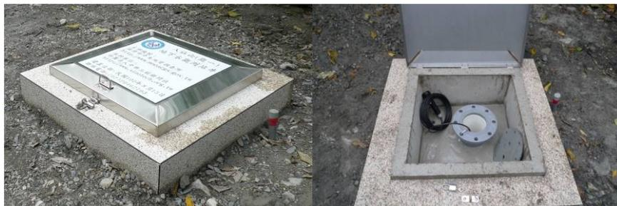
圖七、地下水觀測站體
