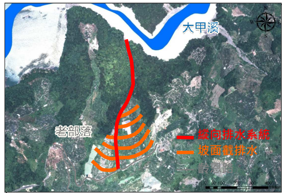
圖 4 老部落地表排水工程系統性規劃示意圖
