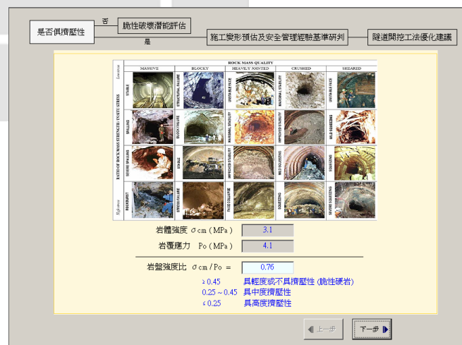
圖 6 案例東引水隧道斷層帶擠壓潛能研判結果
