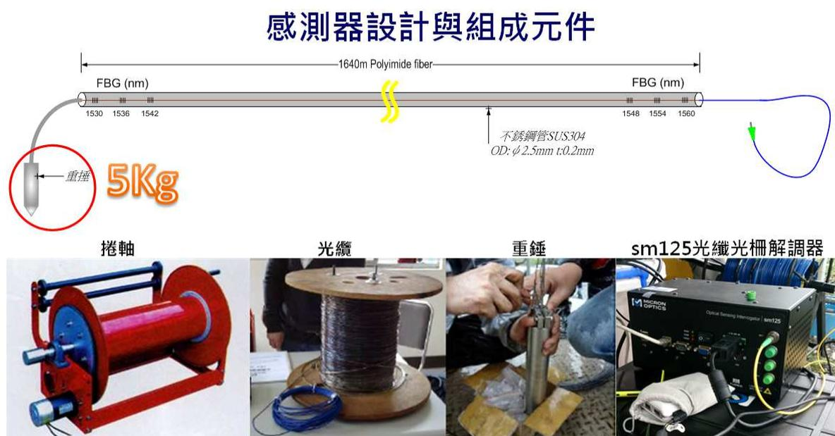
圖 4 光纖井溫檢測硬體設備
