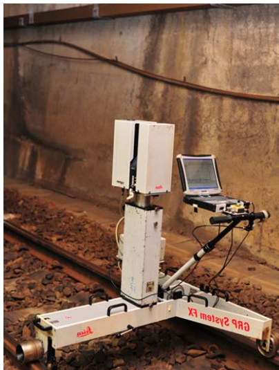
(a) GRP5000 隧道影像掃描系統現場組裝工作照片
