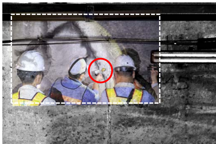
(c) 左邊雷射掃描影像與透明度 50% 之現場照片完整套疊
