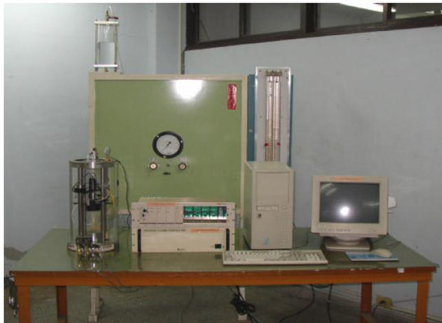
圖 3 Stokoe 型之固定-自由型共振柱試驗儀
