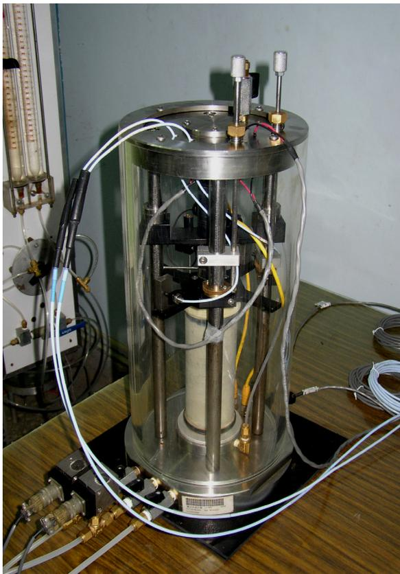
圖 8 共振柱試驗執行狀況
