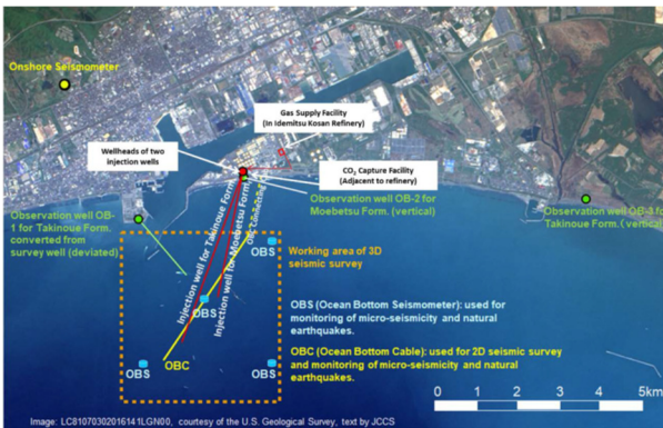
圖 6 場址近域監測設施配置
