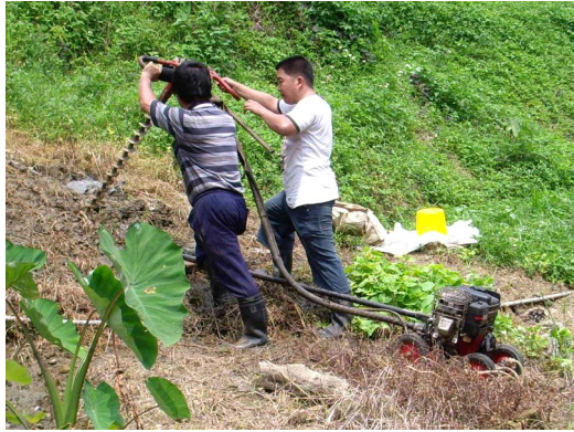
圖 4 機械傳動式土鑽
