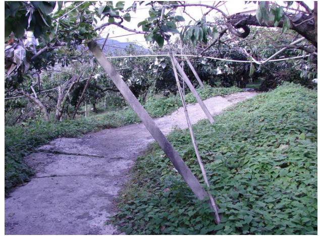
圖2 坡面果園棚架因持續地滑產生嚴重變形
