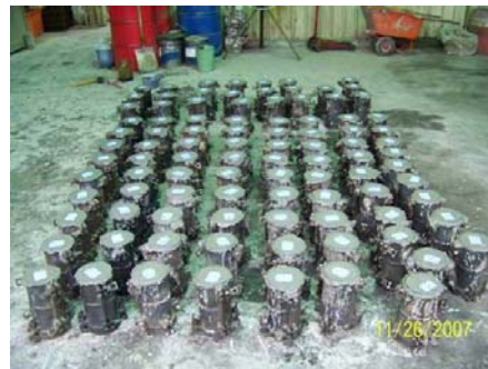
(f) 混凝土圓柱試體全數完成
