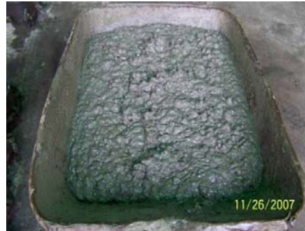
(d) 拌合完成之混凝土狀態
