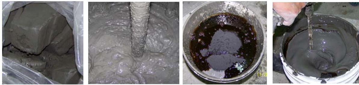
(a)淤泥塊原狀 (b)淤泥攪拌 (c)加入固化劑及強塑劑 (d)再攪拌均勻
