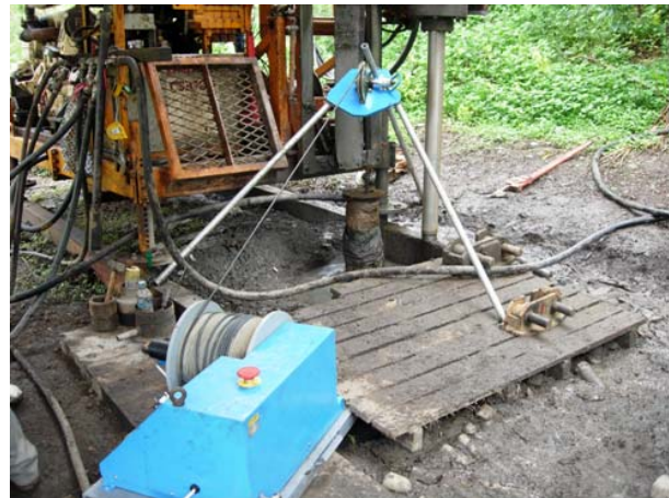
圖 3 捲揚系統(含絞車、三角架、滑輪及吊頭)
