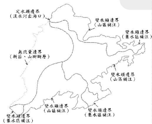
圖 10 台北盆地廣域水文地質模型之邊界條件
